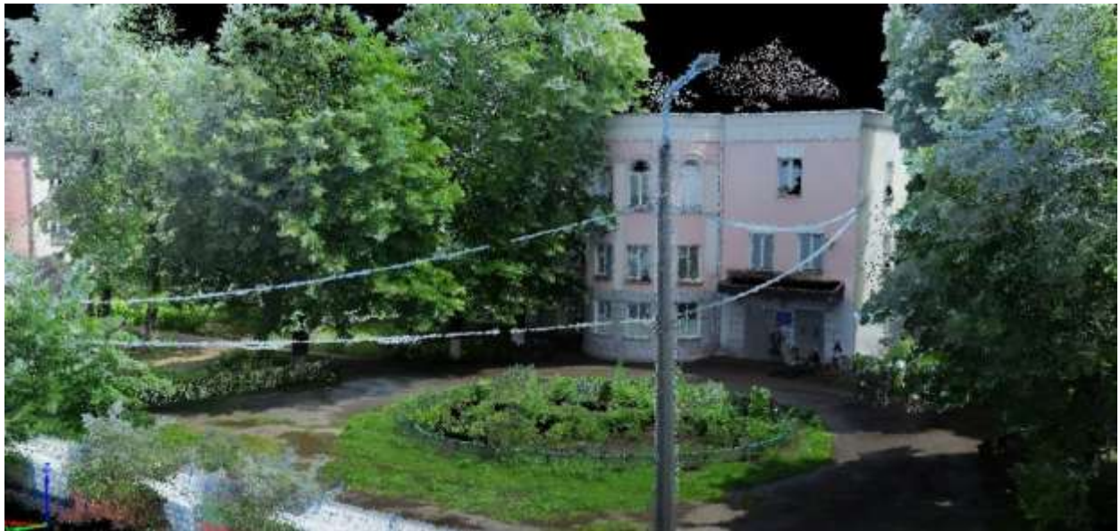
Рис. 1. Фрагмент опрацьованої хмари точок на територію робіт у середовищі CloudCompare
